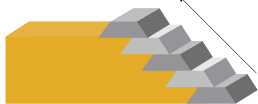
Metode Upstream Lifting untuk Konstruksi Tanggul TSF
